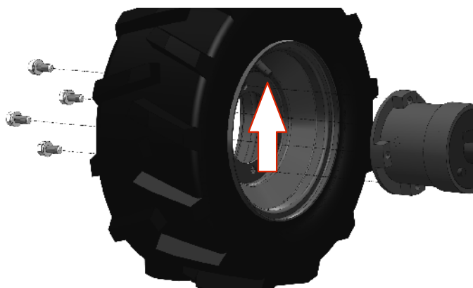
Obr. 2: Montáž kola pro rozchod kol 500mm pro F-600 , F-700 , BDR-1200
