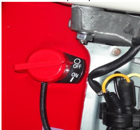
Vypínač motoru v poloze OFF (VYPNUTO)
