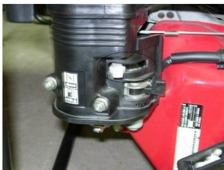
Páčka ovládání sytiče v poloze ZAPNUTO
