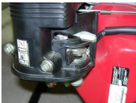
Palivový kohout v poloze OFF (UZAVŘEN)
